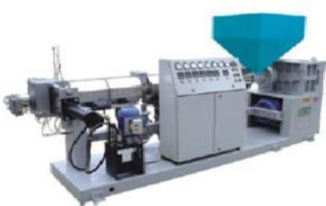
Figura 3.13 Extrusora/ Pelletizadora
