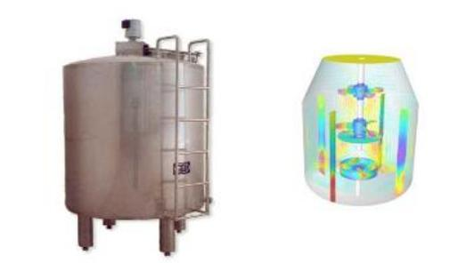
Figura 3.9 Reactor de estaño (polimerización ROP).
