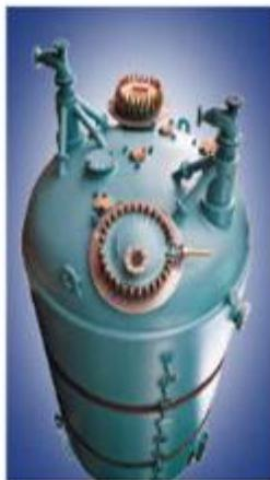
Figura 3.7 Reactor de prepolimerización (policondensador)
