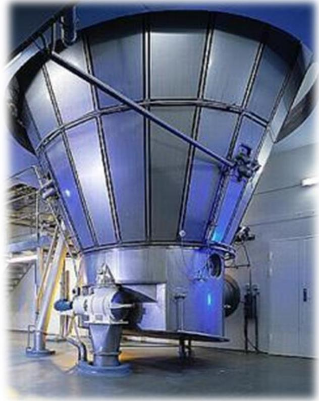
Figura 7.14: Cámara de secado.
