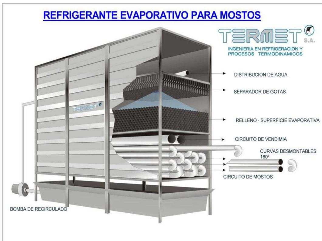
Figura 12 Refrigerante evaporativo para mosto <sup>8</sup>
