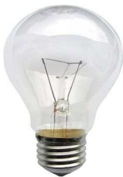
corriente a través de un filamento, normalmente de tungsteno, dentro de un recipiente de vidrio con un gas como argón o nitrógeno. Con el paso de corriente este filamento se calienta a una temperatura cercana a los 2.500° centígrados, generando una pequeña cantidad de luz visible y una gran cantidad de luz infrarroja invisible.
