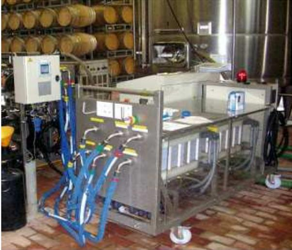
Figura 14 – Equipo de estabilización tartárica de vinos por electrodiálisis <sup>11</sup>
