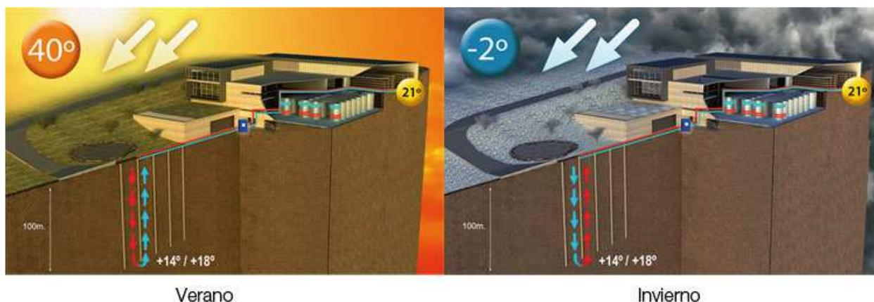
Figura 9 Aprovechamiento de energía geotérmica en bodega <sup>17</sup>
