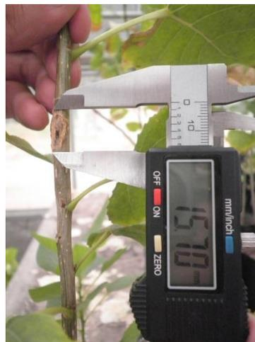
**Figura 13: Medición de la longitud de un cancro utilizando calibre electrónico (Foto del autor).**
