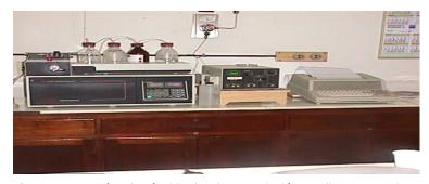
Fig 2.3. Cromatógrafo Líquido de Alta Resolución Konik-500-A series
