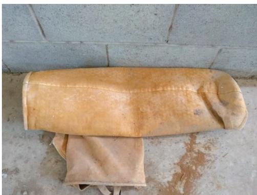
*Figura n° 11. Filtro, posterior a la potabilización*
