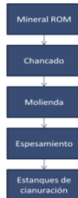
IMAGEN 3 Cianuración por Agitación, Fuente: Marden y House, Química de la extracción del Oro.
