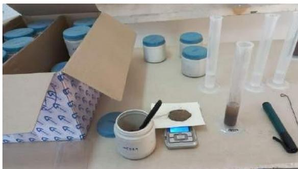
Figura 6: Determinación del volumen de sedimentación.
