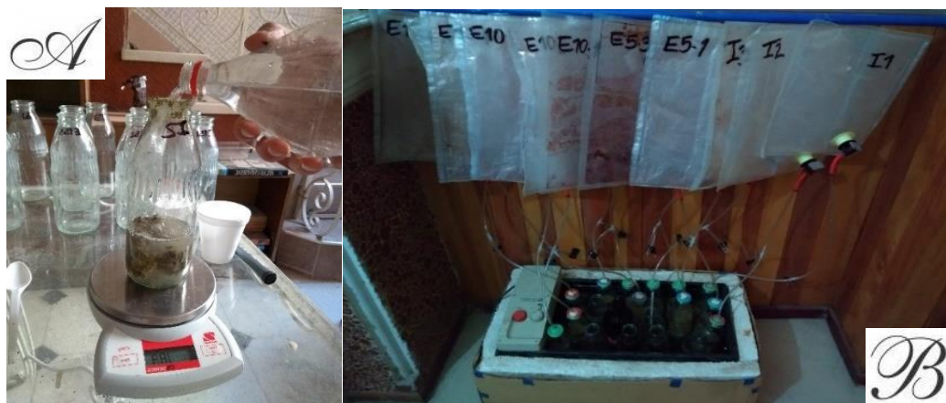
Figura 15: Puesta en marcha biodigestores Batch.
