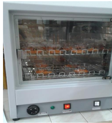
Figura 9 y 10. Balanza y horno de secado para determinación de sólidos totales.
