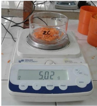
Figura 9 y 10. Balanza y horno de secado para determinación de sólidos totales.
