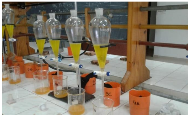
Figura 11. Determinación de \beta caroteno en zanahorias.
