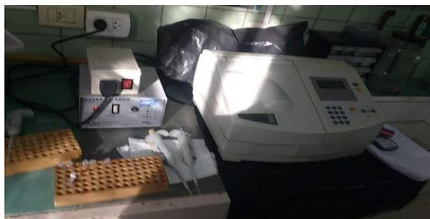
*Figura 15: Espectrofotómetro utilizado para medir la absorbancia. Se observa gradilla con eppendorfs. Fuente: imágenes propias obtenidas durante la realización del trabajo.*
