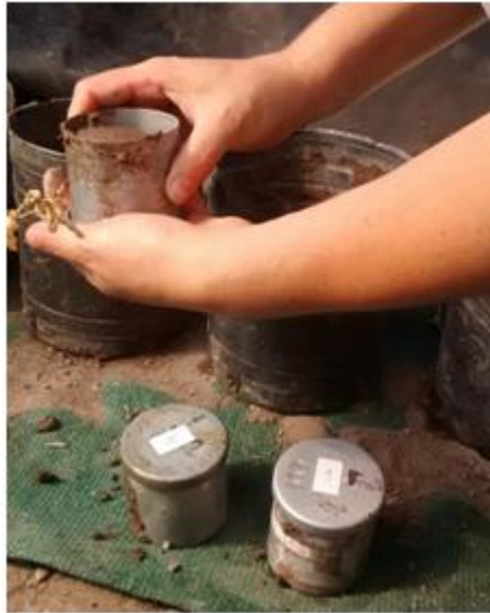
Figura 5. Toma de muestras para capacidad de campo (Izquierda); pesafiltros en estufa 105°C (Derecha).
