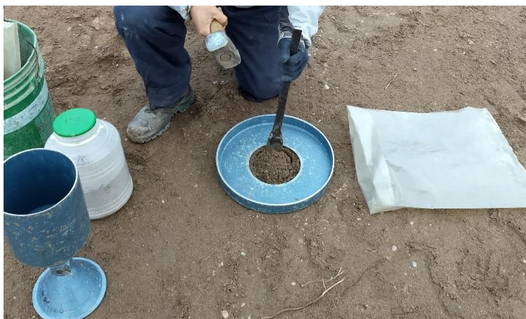
Ilustración 15: Ensayo de densidad por el cono de arena
