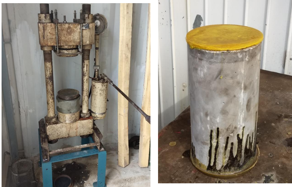
Ilustración 16: Prensa hidráulica y probeta con encabezado de azufre
